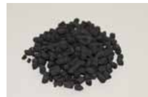
紙のリサイクル資源(左)からできたペーパースラッジとA H Xを混合、A H Xチップ(上)が完成
