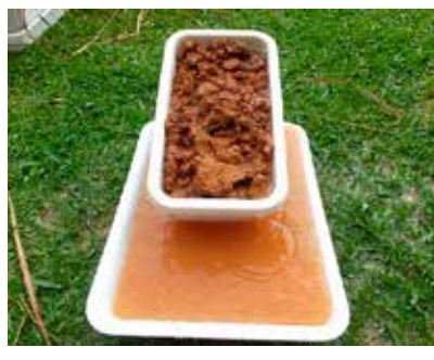
肥料の有無で赤土の沈殿時間が異なることを確かめたり(上)、土が水に浸食される様子を確認する(左)など実験を重ねる
