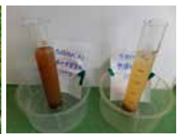
肥料の有無で赤土の沈殿時間が異なることを確かめたり(上)、土が水に浸食される様子を確認する(左)など実験を重ねる
