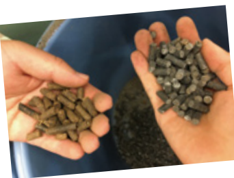
完成した松葉ペレット。燃料として使えば灯油よりCO 2 排出量が少ない
