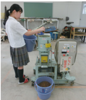
松葉をペレット製造機にかけると(右)、粉碎され、円筒状に圧縮されて出てくる(下)
